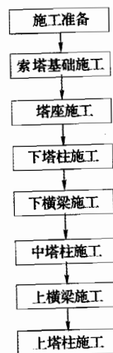
图 17.2.1 索塔施工流程图
