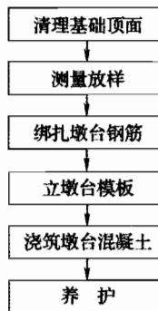
图 9.1.1 墩台施工流程图
